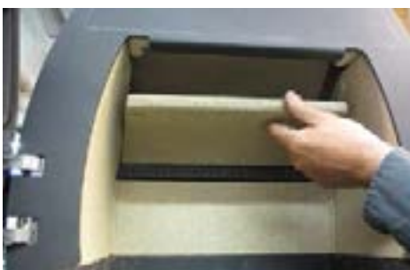
19 Ułożyć płytę tak, aby oparła się na szynie z otworami powietrznymi
