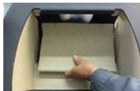
15 Zamontować górną płytę dopalającą (wyżłobienia obrócone do tyłu)
