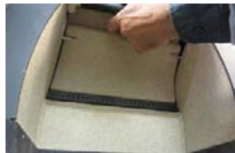
21 Zamontować zatyczki w płytach bocznych
